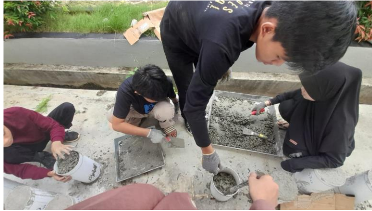
Gambar 4. Campuran Beton Dicitak Dalam Mall
