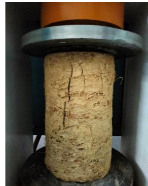
5 Gambar 7. Uji Kuat Tekan Beton
