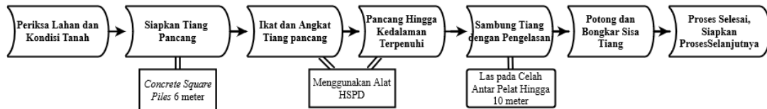
Gambar 6 Proses Pemancangan
